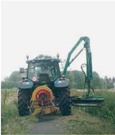
De klepelmaaier verkleint het maaisel heel erg.
