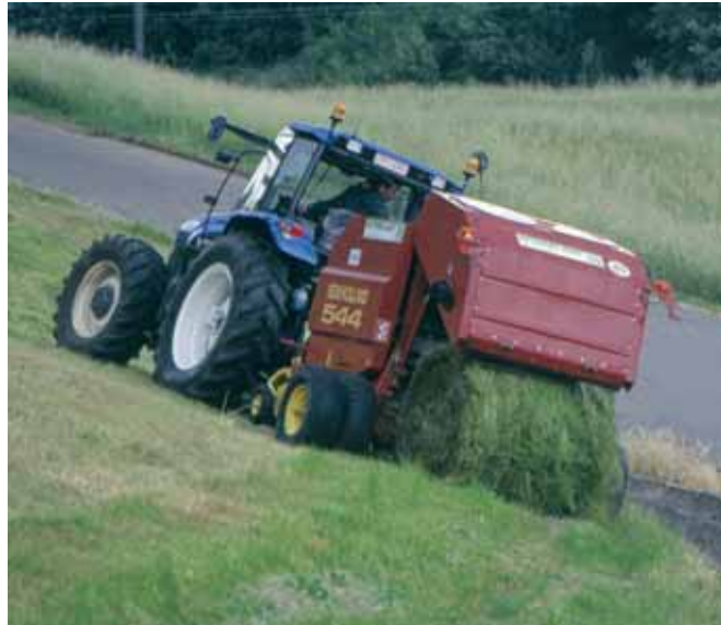
De oprolpers levert cilindervormige balen.
