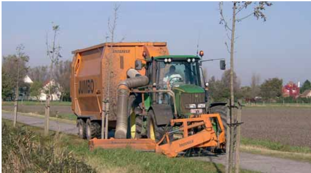
Het gebruik van een maai-zuigcombinatie compacteert het maaisel heel erg.
