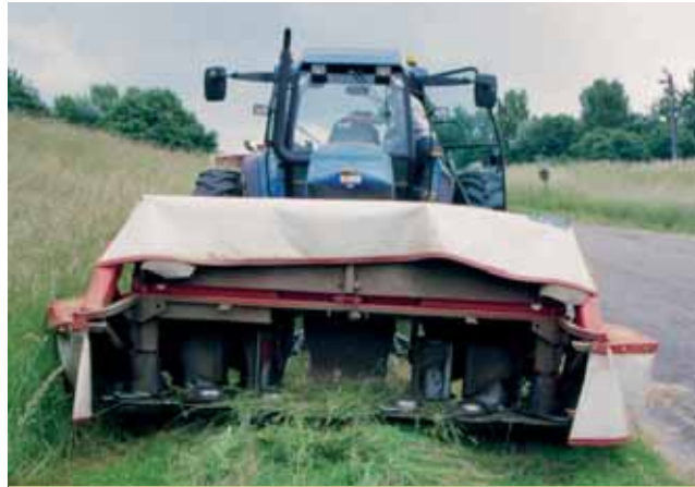
Maaien met een schijvenmaaier levert lang, structureel maaisel.
